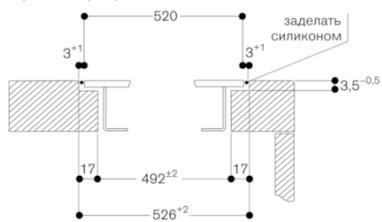
При монтаже с крышкой прибора или выравнивающей планкой, обратите внимание на обратите внимание на глубину выреза и ширину заднего и переднего пазов.
